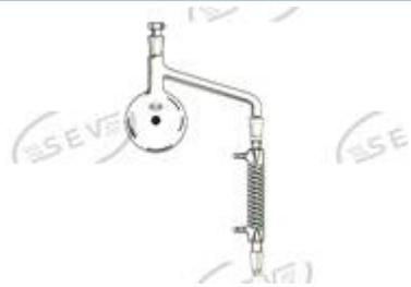
Aparato destilador para determinación de nitrógeno amoniacal
