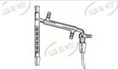
Integral con columna Vigreux para destilación al vacío
