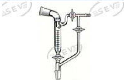
Receptor de destilación al vacío graduado
