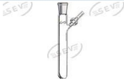
Tubo de Reacción y Almacenaje SCHLENK con junta Hembra
