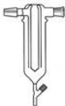
Trampa de frío de alta eficiencia
