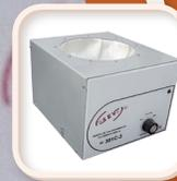
Manta para reactor cilíndrico fondo esférico
