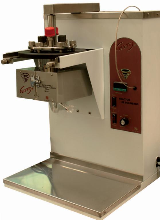
Se presenta este equipo con soporte de acero, manta de calentamiento, reactor de vidrio con tapa de acero inoxidable, control de temperatura digital, control de velocidad.
