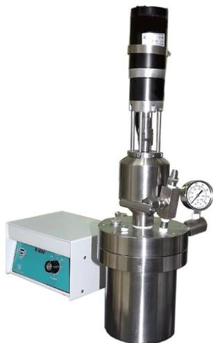
Es fabricado en acero inoxidable 316, que se suministra desde un volumen de 100 ml. hasta 2000 ml., diseñado para trabajar hasta 350°C con una presión de 500 PSI.
