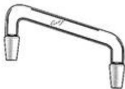
Adaptador puente de destilación con ángulo de 75° y juntas paralelas
