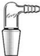
Adaptador junta cónica para manguera
